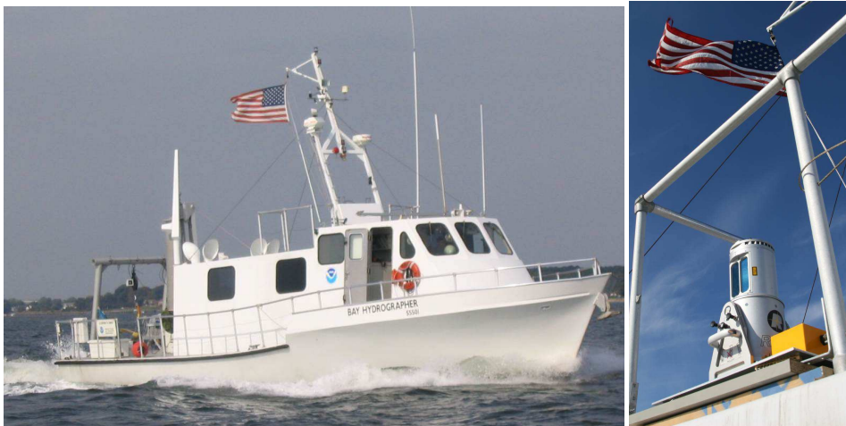
Abb. 6: Mobile Laser Scanning Meßsystem montiert am NOAA-Meßschiff “Bay Hydrographer” in Norfolk Virginia USA (Verwendung der Bilder und Daten mit schriftlicher Erlaubnis der NOAA).
