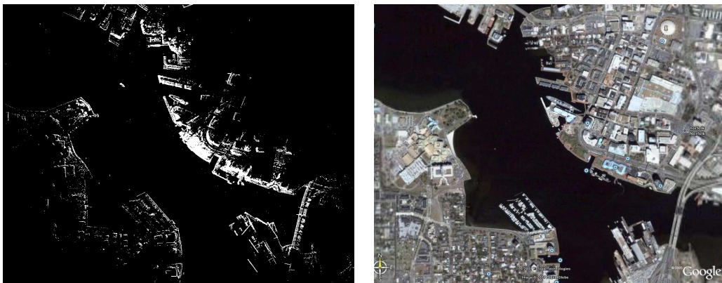
Abb. 8: Mobile Laser Scanning Punktwolke aus der Vogelperspektive im Vergleich zu einer Luftaufnahme von Google Earth (Hafen von Norfolk / USA)
