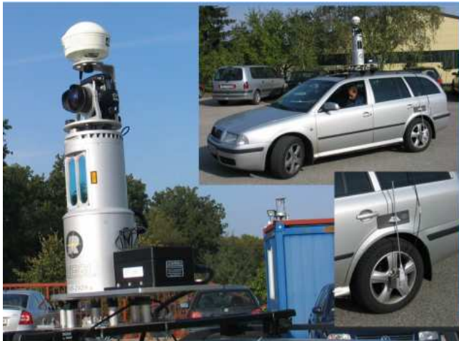
Abb. 2: KFZ basiertes MLS-System
