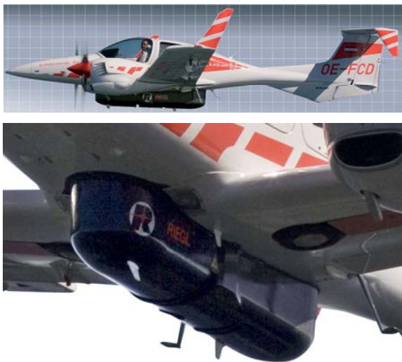
Рисунок3: Бортовая система лазерного сканирования на основе двух RIEGL LMS-Q560 и Diamond Airborne Sensing DA42 MPP.
