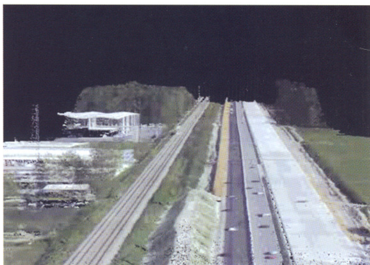
3D-Rekonstruktion einer Bahntrasse aus ALS-Daten
